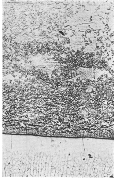
Fig. 4. Stahl 9 mit 3·62% Ni, 60 Minuten bei 498° verzinkt.
