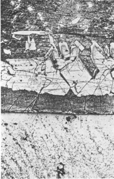
Fig. 8. Stahl 1 mit 2·61 % Mn, 60 Minuten bei 450° verzinkt.
