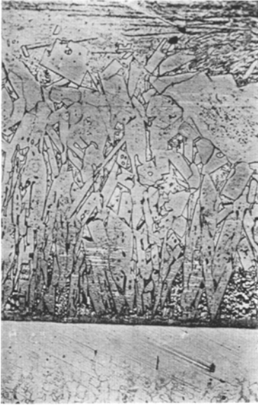
Fig. 3. Stahl 9 mit 3·62% Ni, 60 Minuten bei 470° verzinkt.
